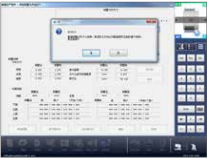
激光识别计测出实际尺寸，更新数值
